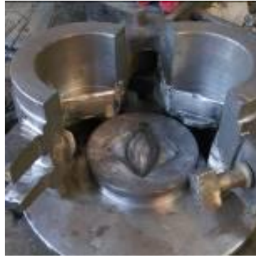
شكل رقم (9) شكل القالب الذي تم تصنيعه من قالب نفخ ليناسب طريقة الكبس لمتعدد من القواعد المستخدمة
